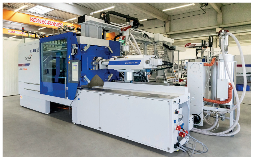
Auf der Anlage wird ein seriennahes, voll funktionsfähiges Konzeptbauteil für den Dachhimmel im Automobilenraum gefertigt. © Wittmann Battenfeld
